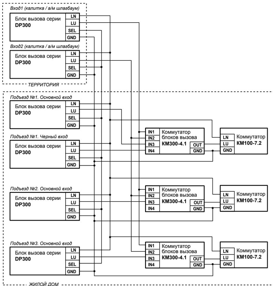
Рис.3 Схема подключения KM300-4.1 к домофонному комплексу
