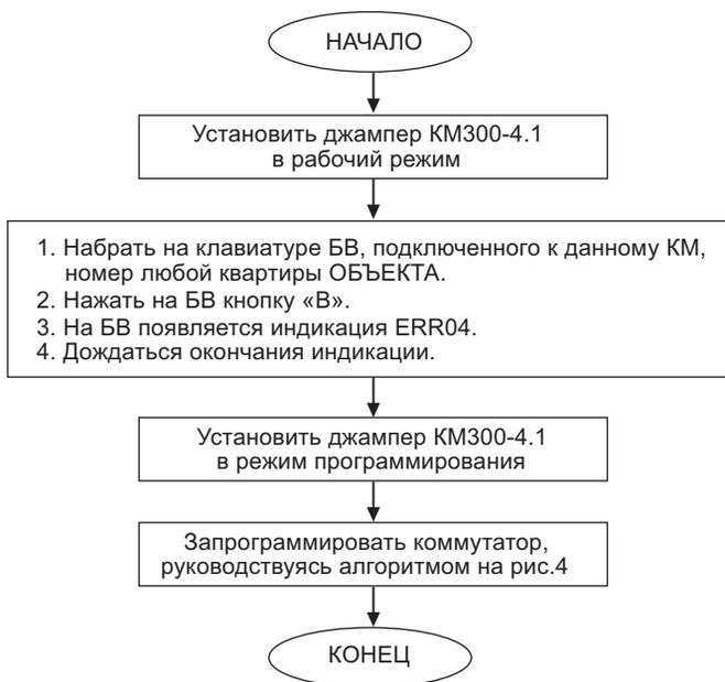
**Рис.5** Процедура при неправильном вводе номера квартиры
