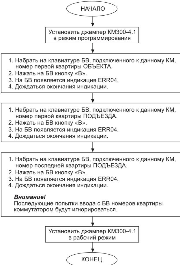
**Рис.4** Алгоритм программирования КМ300-4.1
